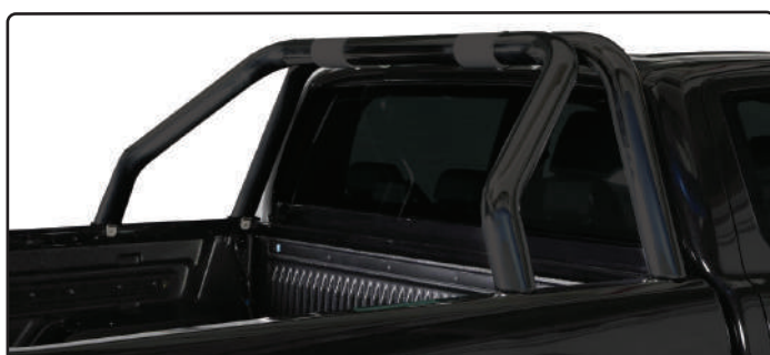
ROLL BAR NEW DESIGN - Double tube Ø 76 mm Noir : R295N
