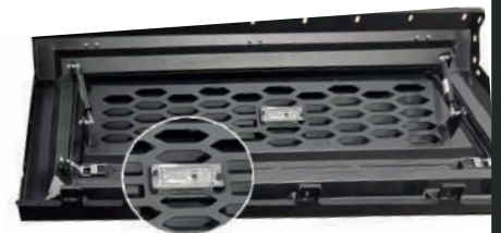
Hard Top livré avec 3 lampes intérieures, fixées sur chaque couvrant
